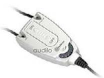
Collier magnétique Amplicom NL 100 : le collier se place autour du cou. Pour écouter, il suffit de basculer son implant en mode « T ». Le signal audio est directement envoyé via la boucle à induction.
